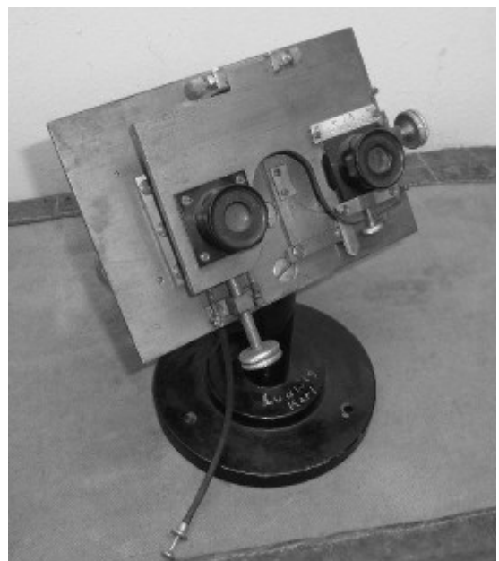
Abbildung 22: Am Institut gebauter Stereokomparator für das Format 2x3 Zentimeter
