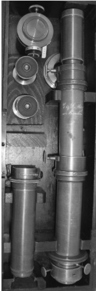
Abb. 21: Dreizölliges Stativfernrohr mit Zubehör
