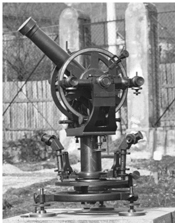
Abb. 10: Universalinstrument auf dem dafür vorgesehenen Betonsockel
