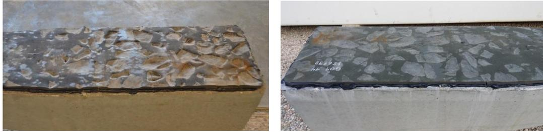
Abbildung 11: Elastische und plastische Material-Eigenschaften von Schwellenbesohlungen kombiniert: Prognostizierte und gewünschte Schottereindrücke unmittelbar nach dem Ausbau (links) und drei Wochen später - vollständige Rückstellung (rechts)
