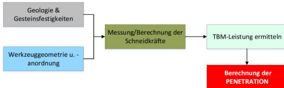
Abbildung 4-6: Vorgangsweise zur Penetrationsermittlung nach dem Modell der CSM [10]
