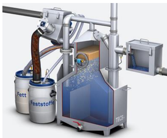
Abbildung 2: Schematische Darstellung eines Direktfettabscheiders (TECE Basika 2007b).
