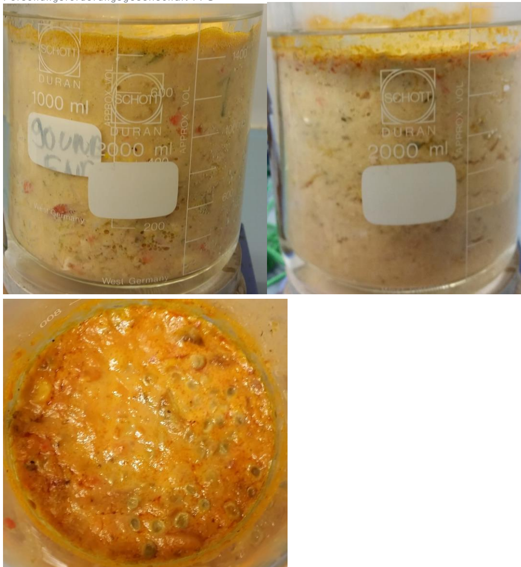
Abbildung 5: Speisereste nach gravimetrischer Trennung bei 60°C; links: Nach 2h zeigt sich ein gelblicher Schaum auf der Oberfläche; rechts: nach gravimetrischer Trennung über Nacht zeigen sich kleine Fetteinschlüsse.
