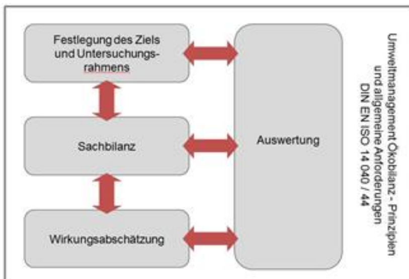
Abbildung 36: Aufbau einer Ökobilanz gemäß DIN ISO 14044ff
