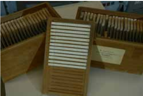
Abb 6: Beaver-Lipson Streifen zur Berechnung von Fouriersumationen.
